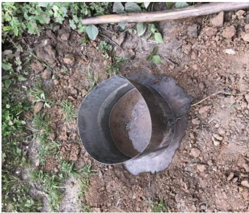
W02 渗水试验照片
