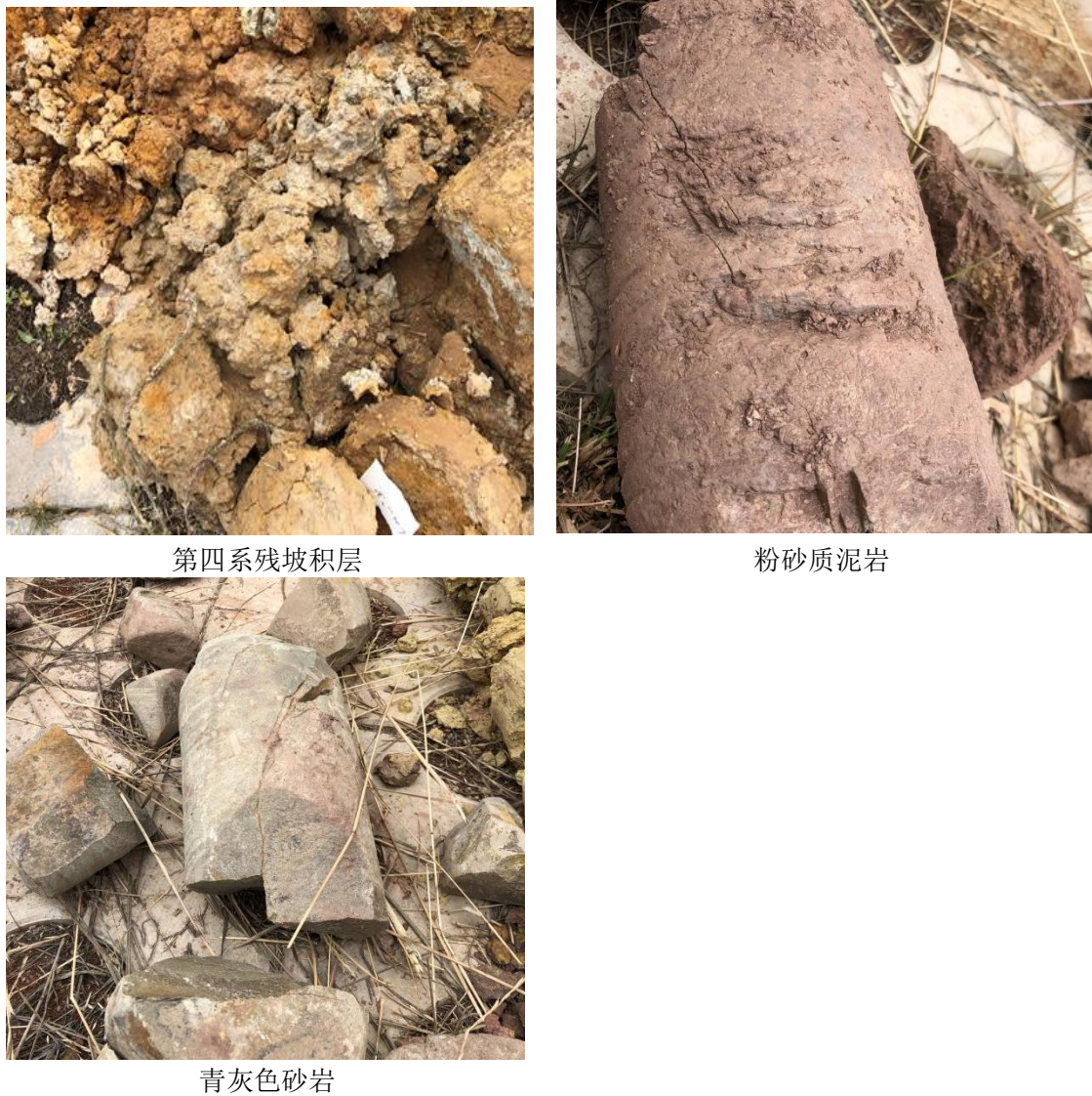
图 5.1-5 场地钻孔岩心照片
